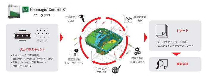
CADベースの寸法管理ツールを使用して迅速に初回品検査を実行し、指先の操作で簡単に結果を共有する情報を用意することができます。 Geomagic Control Xは、製造された部品やアセンブリの品質を大幅に向上させようと考えている人にとって、正確な測定と高速分析を可能 にするソフトウェアです。
